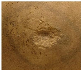
Шлифовальная плитка со следами сверления в центре
